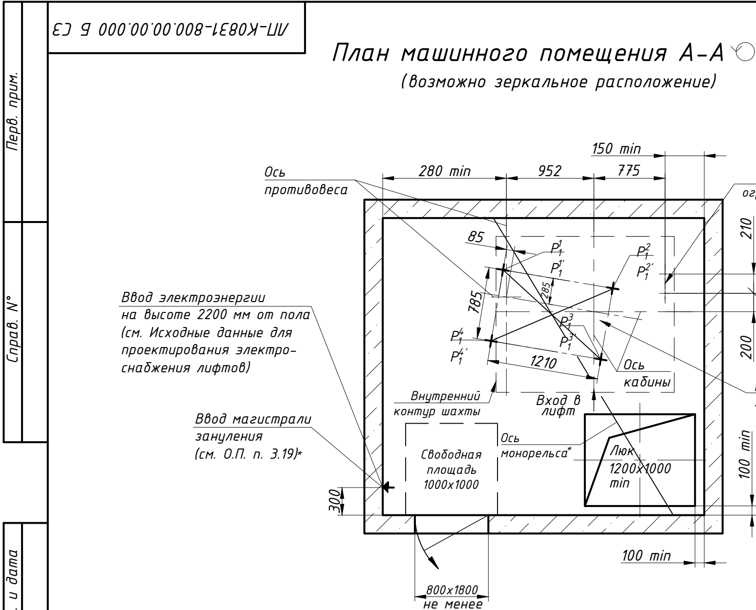
Расположение отверстий в плите перекрытия шахты (возможно зеркальное расположение)
